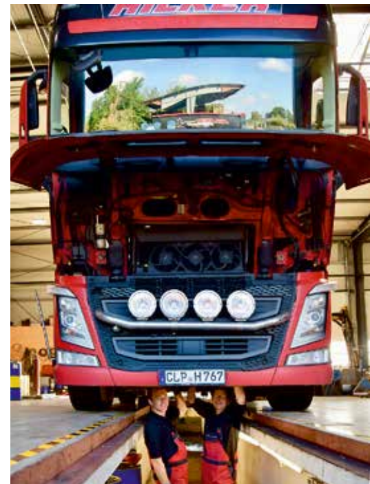
Bild oben links: Werkstatt-Mitarbeiter Jaroslaw Leszczynski (rechts) vor dem Volvo-LNG. Der Flüssigerdgastank fasst etwa 200 Kilogramm womit der Lkw eine Reichweite von circa 1000 Kilometer hat.
