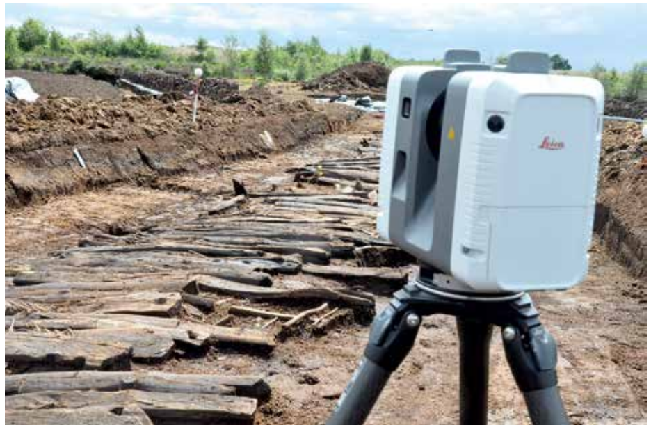
Die Archäologen von denkmal3D haben einen 2000 Jahre alten Bohlenweg im Diepholzer Moor ausgegraben. Damit die Bohlen für einen Erlebnispfad rekonstruiert werden können, scannt das Unternehmen den kompletten Weg.
