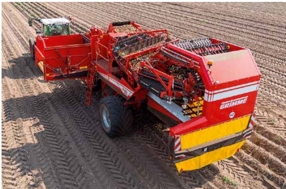
Bodenschonendes Fahrwerk und 8-Tonnen-Bunker: Der zweireihige Bunkerroder GRIMME EVO 280.
