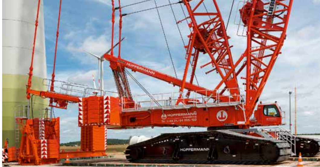
Der Liebherr Raupenkran LR 1750/2 wird vor allem bei Montagen und Instandsetzungsarbeiten moderner Windkraftanlagen genutzt. Mit ihm können Leistungen der 1.000 Tonnenklasse erreicht werden. Foto: Liebherr
