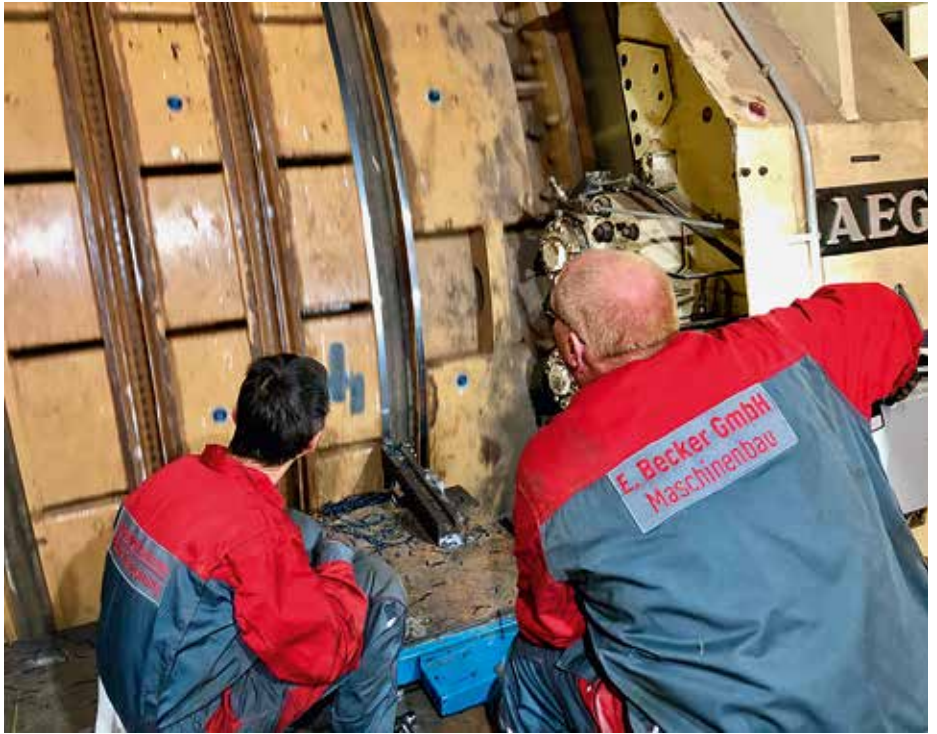
Mobiles Abdrehen einer Fördermaschine im Steinkohlebergbau.
